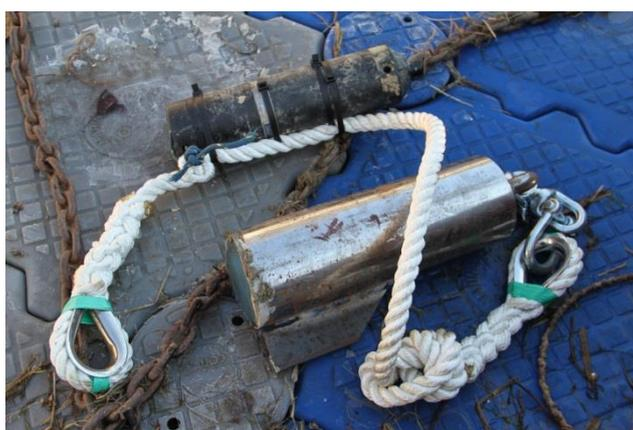
*Ensemble constitué d'un bout terminé par un lest sur lequel est fixé l'hydrophone. Cet ensemble est fixé à une bouée de navigation, une bouée installée sur un corps mort ou un ponton.*
