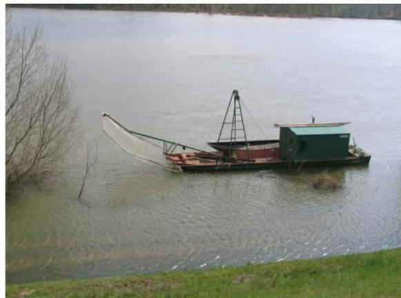
**Figure 9 : La toue et le filet carrelet à l'avant du bateau**
