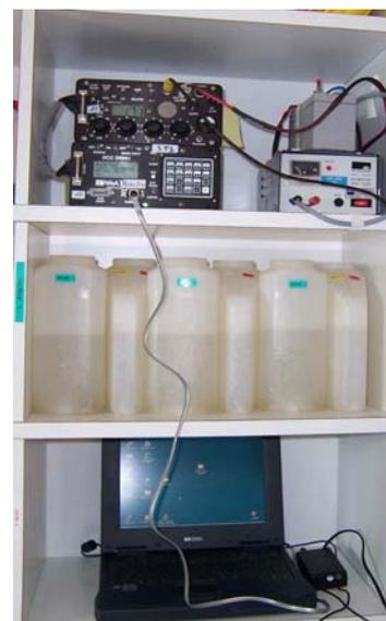
**Figure 22 : Dispositif poste fixe : couplage récepteur/enregistreur relié au PC**
