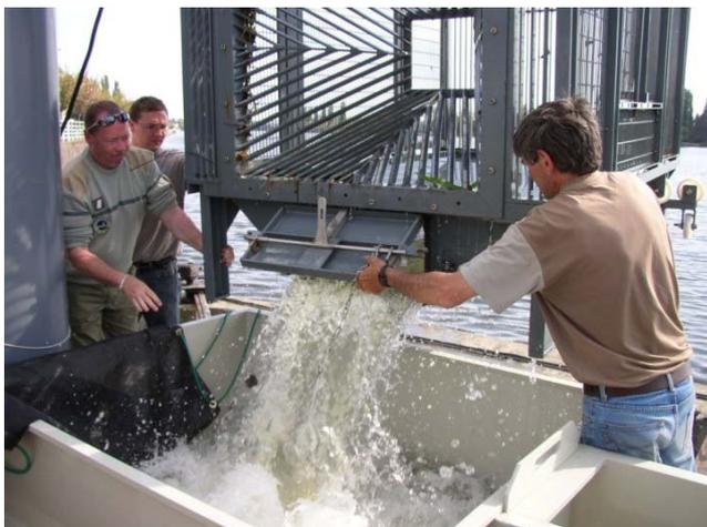
Figure 12 : La cage et sa vanne de décharge
