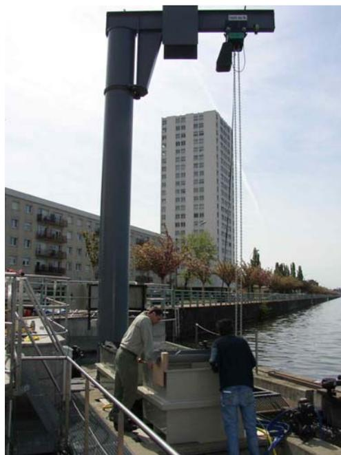
**Figure 11 : Vue de la potence et du palan électrique permettant de relever la cage**
